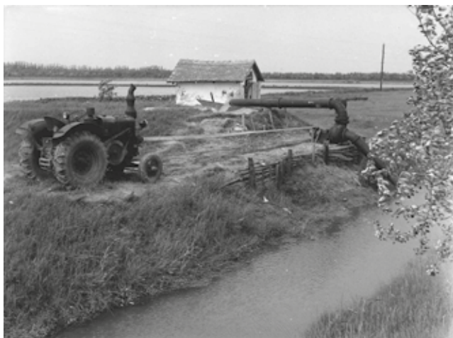
3. kép: Fél-stabil szivattyútelep szivattyújának hajtása traktorról
