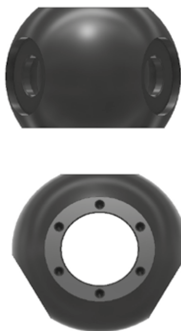
8. ábra. Axiális átömlésű G162 jelű szivattyú állítható járókerék lapátokhoz közvetlenül csatlakozó agyrész 3D geometriai modelljének két nézeti képe
