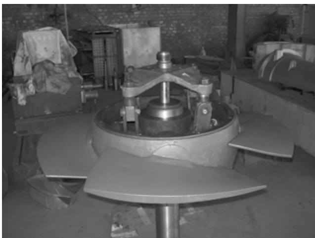
1. kép: Megváltozott üzemeltetési feltételekhez igazított járókerék (Ganz-Vízgép Fővállalkozói Kft.)
