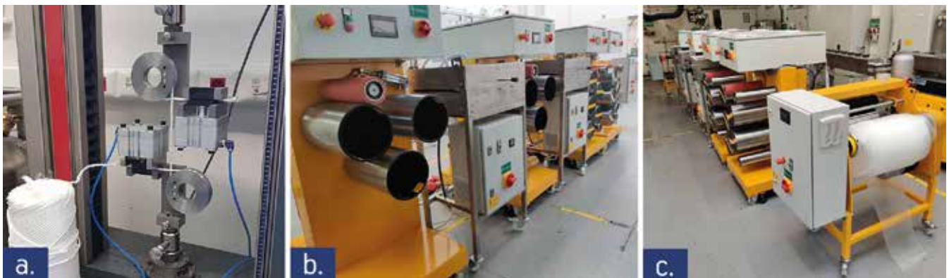
3. ábra A projekt keretein belül megtervezt és legyártott zsinegszakító feltét zsinegvizsgálat közben (a), valamint a beszerzett laboratóriumi nyújtósor (b és c)
