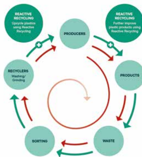
1. ábra: A műanyag életciklusa az újrahasznosítás során. A műanyag minőségének javítása nélkül a tulajdonságai minden egyes ciklust követően egyre romlanak. A reaktív újrahasznosítás révén a Nexam Chemical termékeivel ez elkerülhető.
