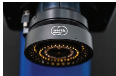
A képfeldolgozó szenzor – ahogy az itt látható, a munkatávolságot és a megvilágítási szöveget is állítani képes szabadalmaztatott Werth Zoom – az egyik leggyorsabb és legpontosabb érzékelő
