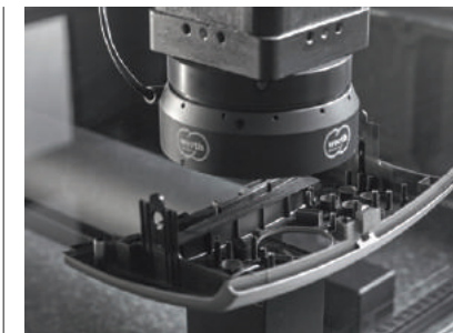
A szabadalmaztatott Werth Laser Probe-t a Werth Zoom képfeldolgozó rendszer fényútjába helyezik
