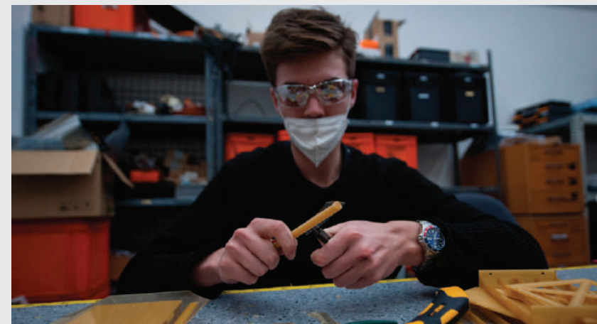
Az akkumulátordoboz alkatrészeinek sorjázása
