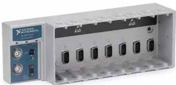
6. ábra A 781156-01 jelű CompactDAQ alapeszköz (Digi-Key cikkszám: 2770-781156-01-ND) nyolc bővítőhellyel és nagy sebességű USB 2.0 illesztőfelülettel rendelkezik (kép: NI)
