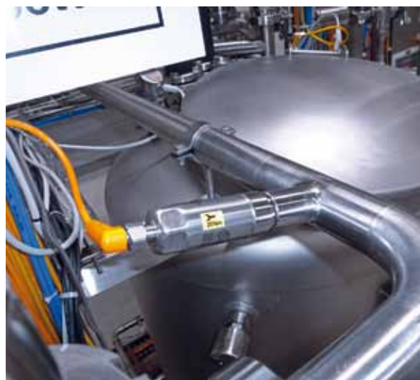
2. ábra A hűtőkörben lévő közeg folyamatos felügyelete
