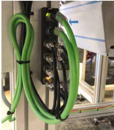
2. ábra A Cube67 kompakt modul fedélteti beszerelése M8 portokkal
