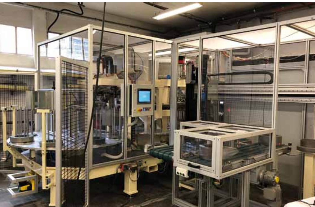
1. ábra Az állórész-összeszerelő sor tesztelése a Dema gyárban Varazze-ban (SV)
