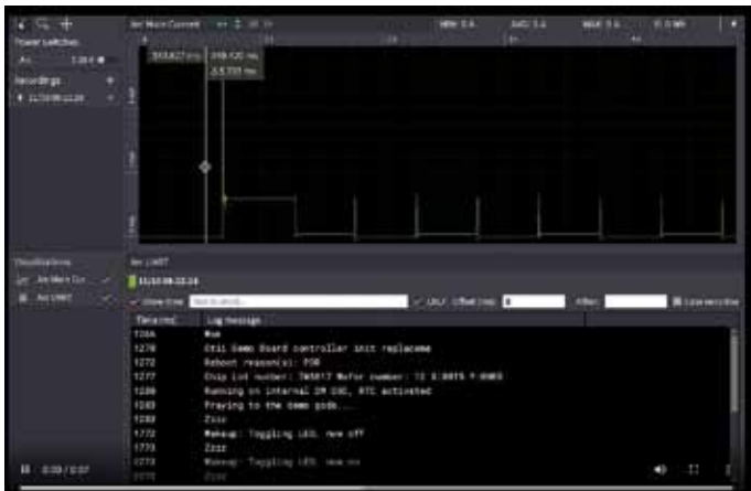
2. ábra Az UART használatával a hibakeresési üzenetek szinkronizálhatók az Otii Arc valós idejű árammérési adataival (forrás: Qoitech)
