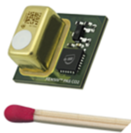
3. ábra A XENSIV™ PAS CO 2 -érzékelő mérete mindössze 13,8 × 14 × 7,5 mm
