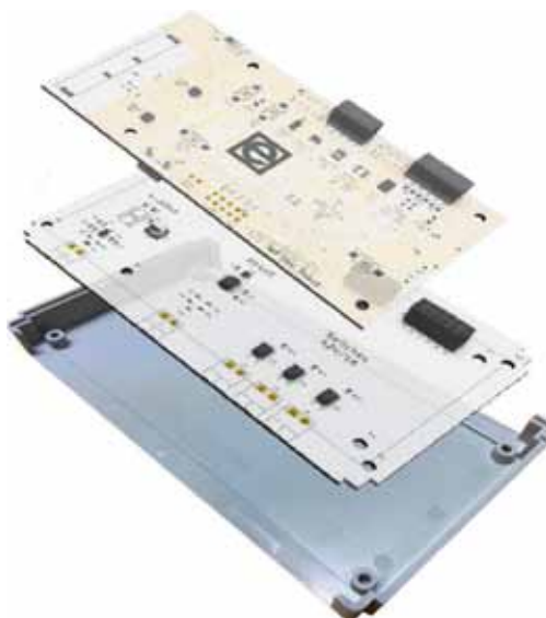
7. ábra Az Endrich IoT SBC és az öt befogadó passzív alaplap 4-20 mA / RS485 ipari interfésszel és FET teljesítményfokozattal
