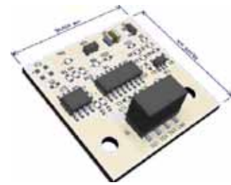
3. ábra Az Endrich külső perifériaként illeszthető szenzor sztenderd kártyacsaládjának elemei (SPI & I 2 C)
