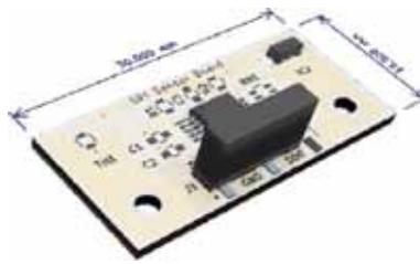
3. ábra Az Endrich külső perifériaként illeszthető szenzor sztenderd kártyacsaládjának elemei (SPI & I 2 C)
