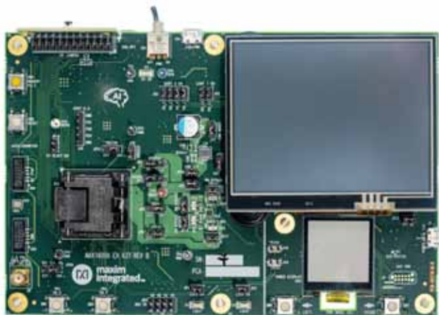
2. ábra A Maxim MAX78000 egylapkás rendszerre épülő MAX7800 kiértékelő készlete színes érintőképernyővel, mikrofonnal, giroszkóppal és gyorsulásmérővel (Forrás: Maxim Integrated)
