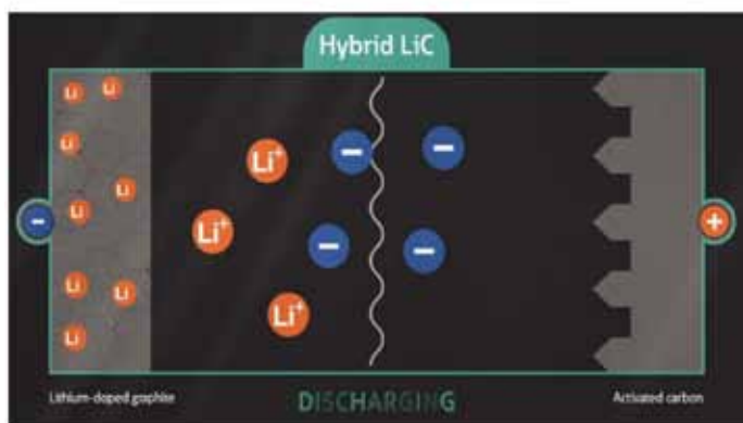
4. ábra A hibrid szuperkondenzátoroknál – egyéb előnyeik mellett – nincsenek jelen a töltési/kisütési ciklusok számára és a sebességekre vonatkozó korlátok, amelyek az akkumulátorokra jellemzők (Kép: Eaton – Electronics Division)
